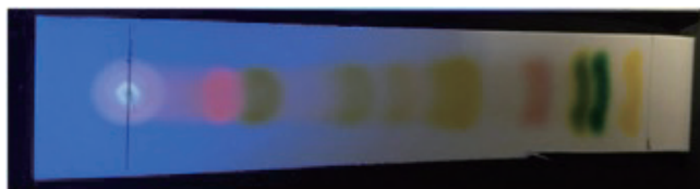
図1 スギナ抽出物のTLC(ブラックライト照射) 左側原点に蛍光が見られる(著者の許諾を得て掲載)。
